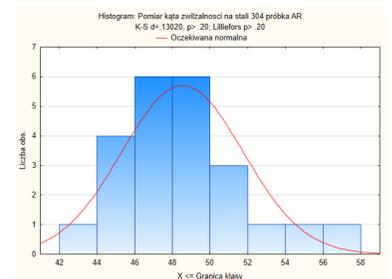
Fig. 9. Distribution of contact angle.
